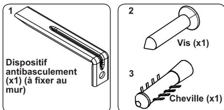
Le sac de documentation contient un kit antibasculement. Fixer le dispositif antibasculement (1) sur le mur à l'aide de la vis (2) et de la cheville (3), conformément aux dimensions de l'illustration et du tableau ci-dessous. Régler la hauteur du dispositif antibasculement pour l'aligner sur la rainure de la cuisinière, puis serrer la vis (2). Pousser l'appareil vers le mur en s'assurant que le dispositif antibasculement est inséré dans la rainure de l'arrière de l'appareil.
