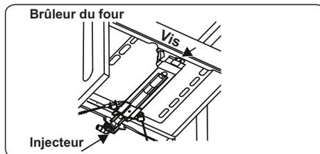
Démonter les injecteurs à l'aide d'une clé de 7 mm et les remplacer par ceux du jeu de rechange. S'assurer d'utiliser les diamètres correspondants adaptés au type de gaz qui sera utilisé, conformément au tableau d'information (également fourni dans le kit de conversion de gaz).
